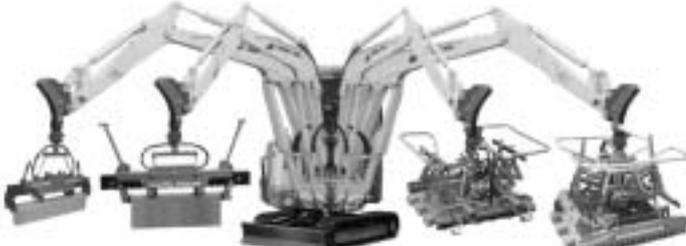
für Borde, Betonplatten, Natursteine und alle Sorten Betonpflaster
