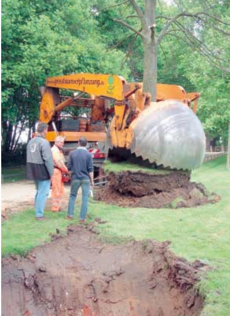
Ballendurchmesser von drei Metern bewältigt dieses technische Gerät zur Großbaumverpflanzung. Mit maschineller Hilfe wurde der abgestorbene Tulpenbaum aus der Allee am Schloss Dyck entfernt.
