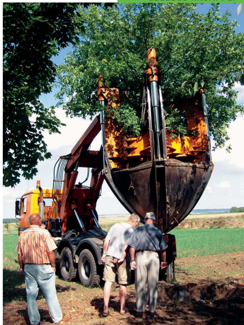
Drei Großbaumverpflanzungen faszinierten die Besucher beim Tag der offenen Tür im Kompetenzzentrum Garten- und Landschaftsbau. Experten zeigten auf: Am neuen Standort kommt es vor allem auf das fachgerechte Verankern des Baumes und auf die Nachsorge (Wurzelversorgung und Anlegen einer Rehabilitationszone) an – so liegt die Anwachsquote bei 95 Prozent.
