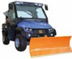
Mit hydraulisch verstellbarem Schild
