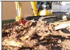
Anbaugerät Wurzelratte im Einsatz
