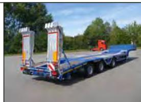
VFR-Federhebwerk von Altec.
