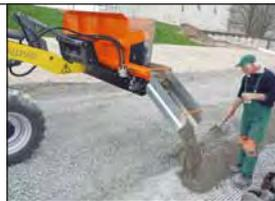
Material präzise verteilen mit dem Finliner.
