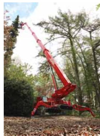
LEO31T – bis zu 14,70 m Reichweite bei 250 kg im Korb, sogar 17,70 m bei 80 kg
