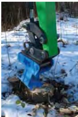
Der „WurzelKönig“ schneidet beim Roden die Wurzeln in brennholzartige Stücke.
