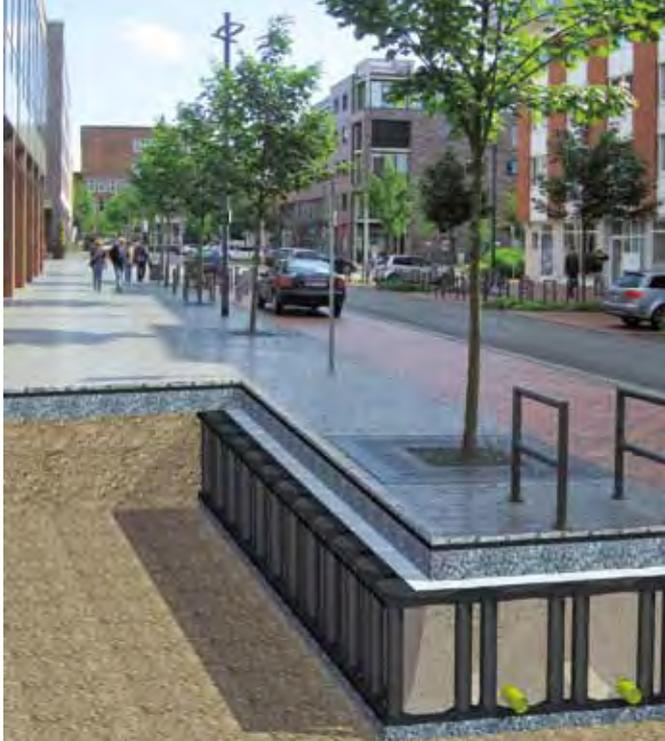
Das TreeParker® System ist mit bis zu 15,5 Tonnen Achslast belastbar.
