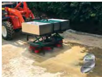
Das Pflaster-Verfugungssystem von Hunklinger kombiniert Absander, Einkehrgerät und Kehrvorrichtung.
