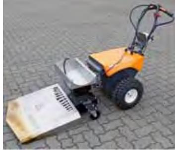
Abflammgerät Hoaf thermHIT mit 75 cm Arbeitsbreite.
