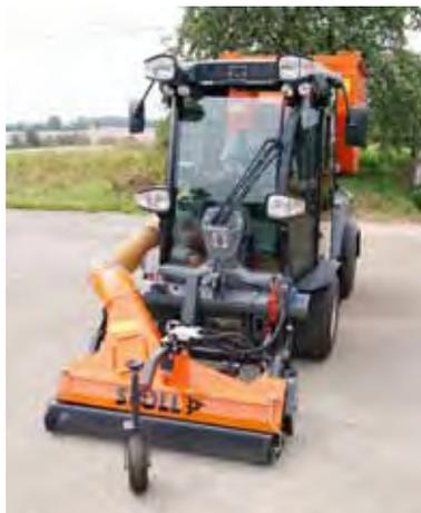
Die neu entwickelte Frontwalze mit pendelnder Aufhängung passt sich automatisch Untergrund und Laubhöhe an.
