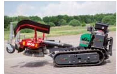
Der neue Geräteträger auf Raupenbasis von LIPCO ist funkgesteuert.
