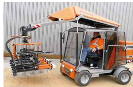
Bequem per Joystick bedienen lässt sich die Verlegemaschine H 99 von Optimas.
