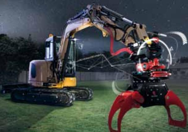
**R2 ist ein neuer Schwenkrotator für 3-6,5 t, mit dem Sie die gesamte Leistung Ihres Baggers ausschöpfen können. Eine beeindruckende Brechkraft und ein hoher Hydraulikdurchfluss in Kombination mit dem intelligentesten Steuersystem (ICS) auf dem Markt und der weltweit führenden Sicherheitslösung (SecureLock™). Das geht nur mit Rototilt!**
