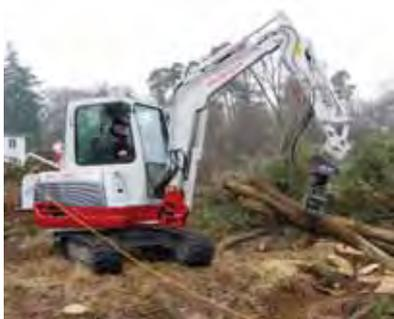
Der Takeuchi TB 235 Hybrid arbeitet bei der Baufeldrodung ausschließlich mit elektrischem Antrieb.
