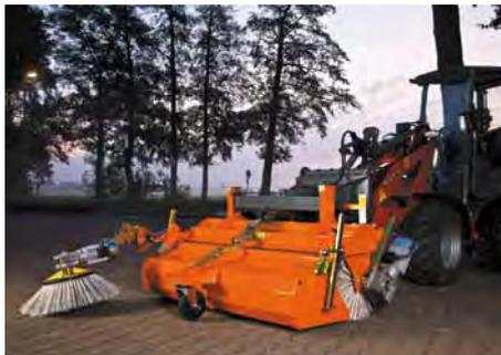
Gekehrt wird jetzt mit E: Die neue E-Kehrmaschine bema 20 Dual E angebaut am eHoftrac® von Weidemann.
