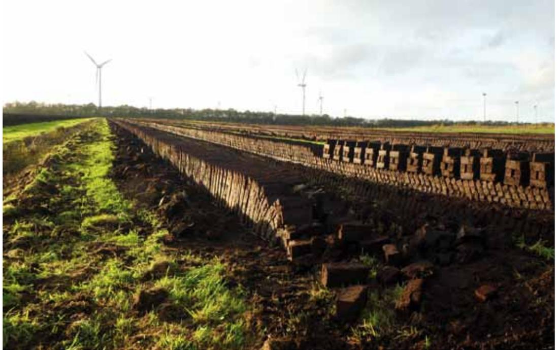
In Hochmoorgebieten wird Torf maschinell abgebaut.
