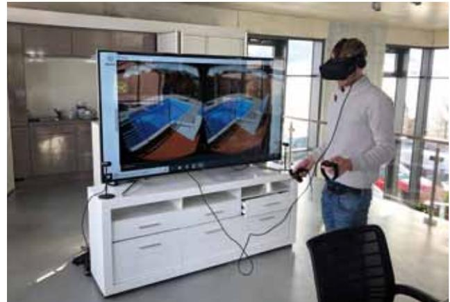
Einsatz von Virtual-Reality. Komplette stereoskopische Projektion (Tiefenwirkung) in der Brille. Monoskopisches Abbild auf dem Fernseher.
