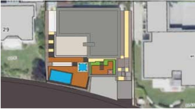
Grundrissplanung eines Terrassenbereiches mit Poolanlage. Grundstücksgrenze und Nachbarbebauungen wurden mittels Katasterunterlagen eingelezen.
