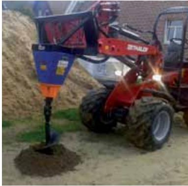
Nur eines der Anwendungsgebiete: Bohrungen für Baumpflanzungen oder Fundamente.
