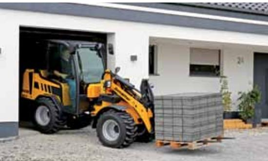
Dank seiner kompakten Abmessungen eignet sich der neue Schäffer 2430 SLT auch für den Einsatz bei niedrigen Tor- und Türdurchfahrten oder in Tiefgaragen.
