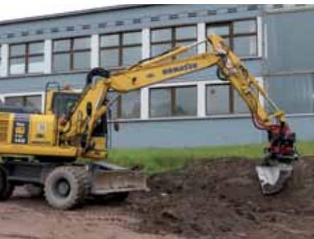
Mit dem Schwenkrotator R 4 und dem Tieflöffel von Rototilt werden beim Böschungsbau perfekte Ergebnisse erzielt.
