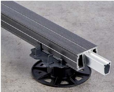
Die „WPC 2.0“ erweitert mit einem klugem Alu-Innenleben die Palette der passenden Unterkonstruktionen bei Naturinform. Die bisherige Überspannung von 60 Zentimeter kann durch das Einschleiben des neuen Profilverstärkers aus Aluminium auf 100 Zentimeter erhöht werden, damit wird die Anzahl der Auflagepunkte, ebenso wie die der Terrassenfüße eingespart und reduziert damit auch die Kosten.
