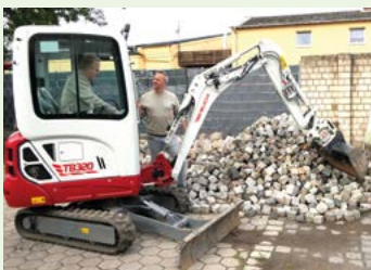
Der Takeuchi TB 320 mit dem Taklock-Schnellkupplungssystem macht den Wechsel hydraulischer Anbaugeräte einfach. Gärtnermeister Sven Busse und Oliver Knabjohann (v.l.).
